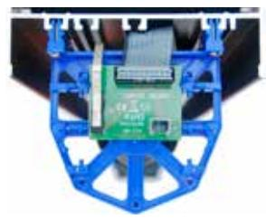
Avisa de qualquer tentativa de manipulação da coluna. Para as colunas á parede, 2 unidades incluidas, um por cada lado. Contém um conector para fixar o tamper anti-escalado.
