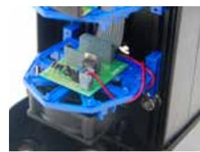
Configurável para funcionar á baixa temperatura com os aquecedores, para evitar a condensação ou á altas temperaturas circulando o ar melhorando o desempenho dos equipamentos.
