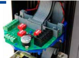
Controla cada Rx/Tx na coluna como os periféricos (aquecedor, tamper e ventilador) para evitar a condensação, inclui um termostato que activa os aquecedores e ventiladores, e se forem configurados, caso de baixa temperaturas. Inclui saídas de alarme, tamper anti-sabotagem, anti-escalado e desqualificador ambiental dos feixes fotoeléctricos.
