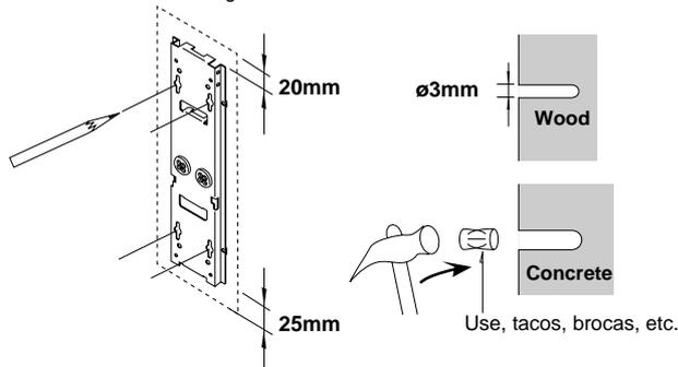
(2) Instale el sensor, sobre una superficie totalmente plana.
