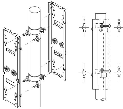
Coloque las abrazaderas sobre el caño en dos pares, uno en la parte superior y el otro en la parte inferior, oriente las caras de las abrazaderas de cada par en direcciones opuestas. (Vea la figura de arriba).
