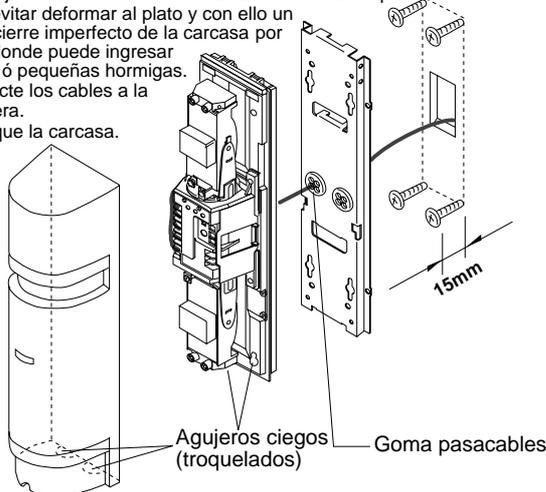
(3) Para montaje de la unidad sobre pared resulta ideal usar una caja embutida en la pared para la acometida de los cables de esta a la parte posterior del sensor.
