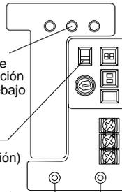
**Audio de alineación; Sin audio ante total desalineación - Ni bien se establece una alineación ó enlace inicial pobre entre el TX y el Rx se escucha un tono grave el cual se va tornando más agudo a mejor alineación hasta llegar a ser muy agudo y casi imperceptible cuando se alcanza la alineación correcta.**
