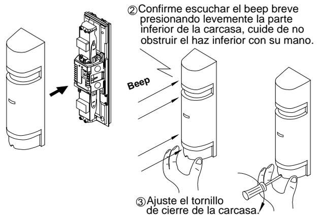
Ante sonido continuo del "beep", extraiga la carcasa y vuelva a alinear. Note el beep breve le indicará que su alineación es óptima, una mejor no puede ser obtenida. Note este beep breve acelera el mantenimiento post-instalación del sistema, ya que luego de limpiar las carcasas con solo abrir la carcasa del RX, sin extraerla y si al volverla a cerrar escucha el beep breve indicará que esa barrera no necesita ser alineada.
